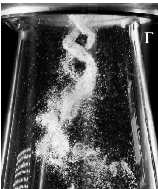
*Рис. 29 Визуализация течения,  $Q = 70 \text{ м}^3/\text{ч}$ ,  $N/N_0 = 1.9$ .*
