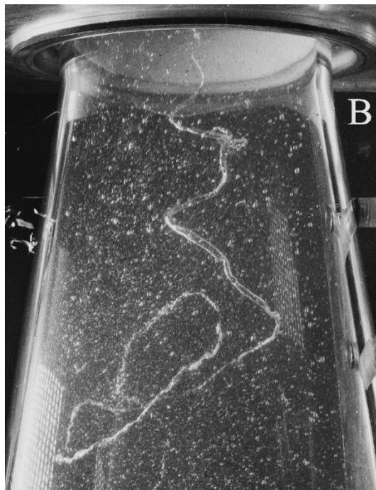
*Рис. 28 Визуализация течения,  $Q = 70 \text{ м}^3/\text{ч}$ ,  $N/N_0 = 1.6$ .*
