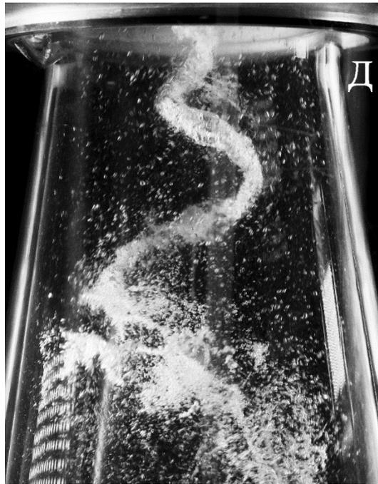
*Рис. 30 Визуализация течения,  $Q = 70 \text{ м}^3/\text{ч}$ ,  $N/N_0 = 2.1$ .*
