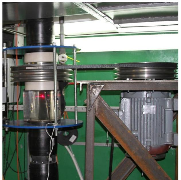
*Рис. 10 Фотографии вертикального кавитационного стенда (общий вид и рабочий участок) и упрощенная схема.*
