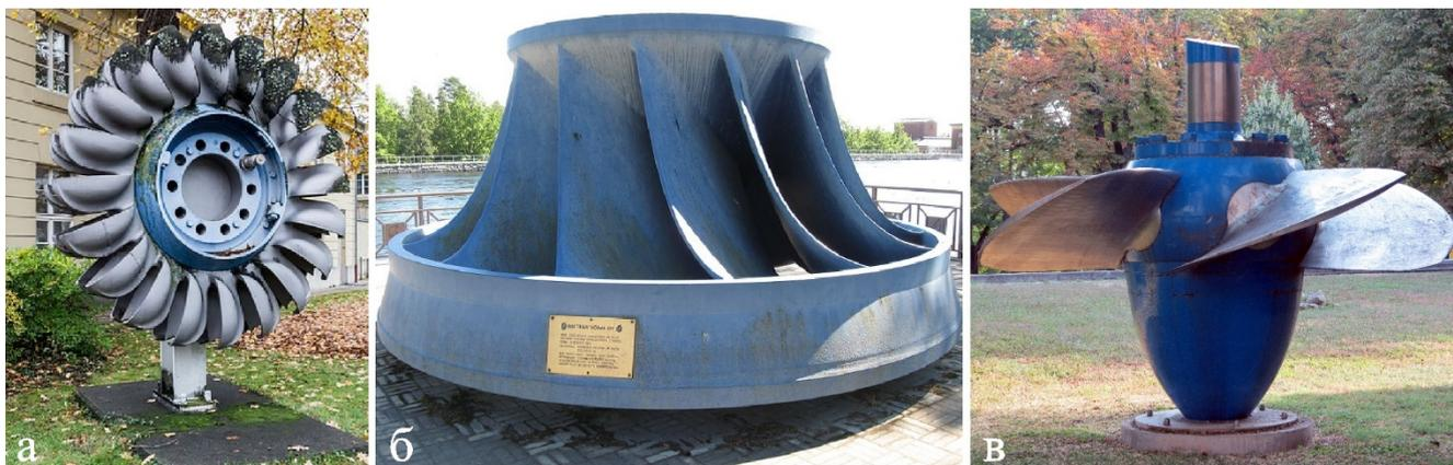
Рис. 2 (а) – рабочее колесо турбины Пелтона, (б) – рабочее колесо турбины Френсиса, (в) – рабочее колесо турбины Каплана.
